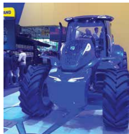
Концепт трактора New Holland, работающий на метане
